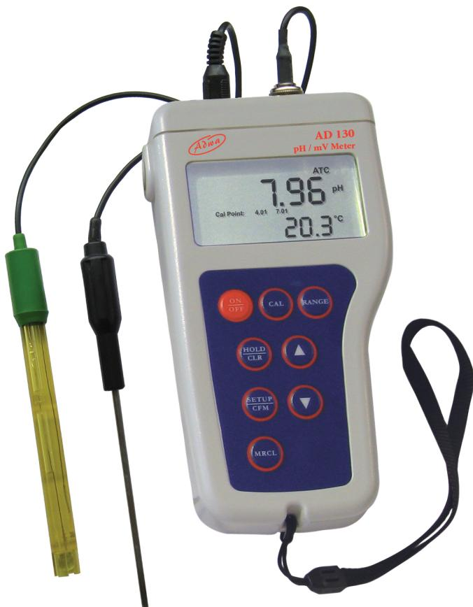
**AD130** est un pH-mètre portable robuste, conçu pour fournir des résultats et une précision de qualité laboratoire, même dans des conditions industrielles difficiles.
