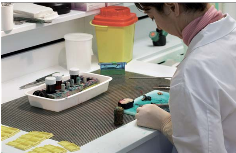
Figure 52. Les vapeurs formolées dégagées lors des observations macroscopiques sur pièces fixées sont aspirées par un système de captage inducteur (fentes en partie frontale du plan de travail) à défaut de sorbonne.
