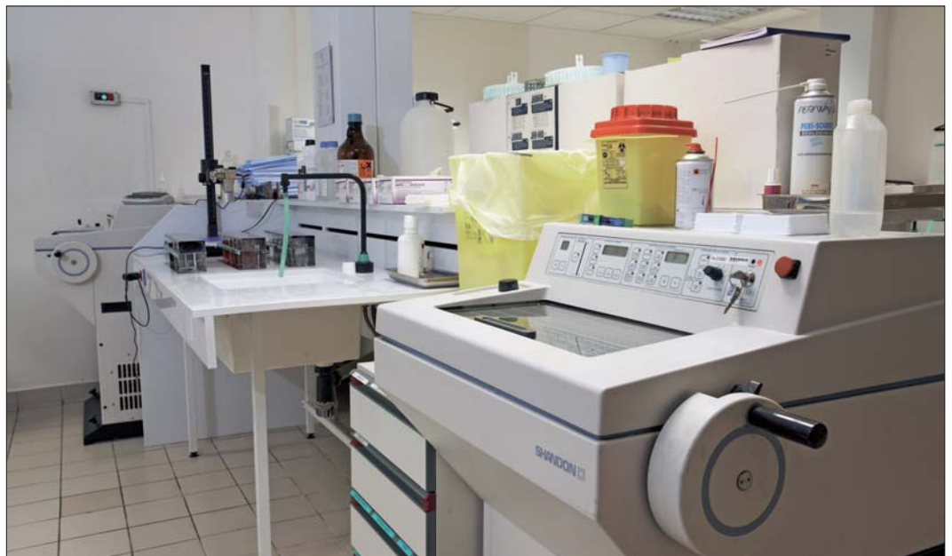
Figure 53. Zone spécifique comprenant des cryostats et des bains de coloration nécessaires aux examens extemporanés.
