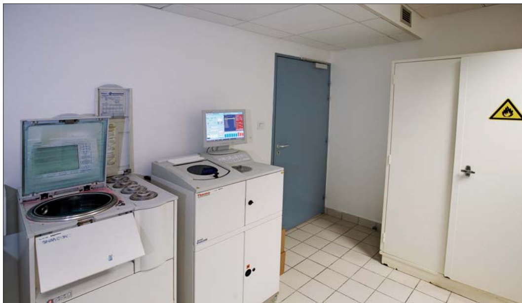
Figure 54. L'imprégnation des échantillons dans des automates situés dans des pièces ventilées permet de limiter les risques pour les salariés.
