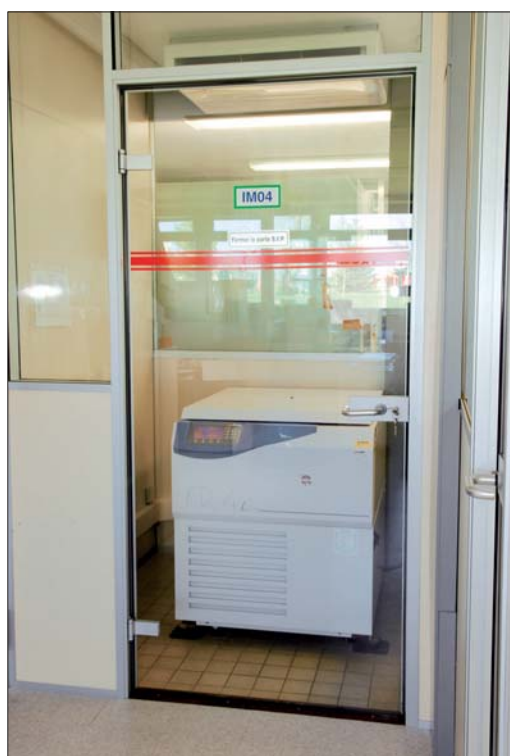
Figure 18. Les appareils bruyants, tels que les centrifugeuses, peuvent être placés dans des salles isolées.
