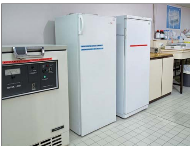
Figures 39 et 40. Selon le volume des activités du laboratoire, les échantillons et les réactifs peuvent être stockés dans des congélateurs et réfrigérateurs placés dans la salle technique (figure 39) ou dans une chambre climatisée (figure 40).
