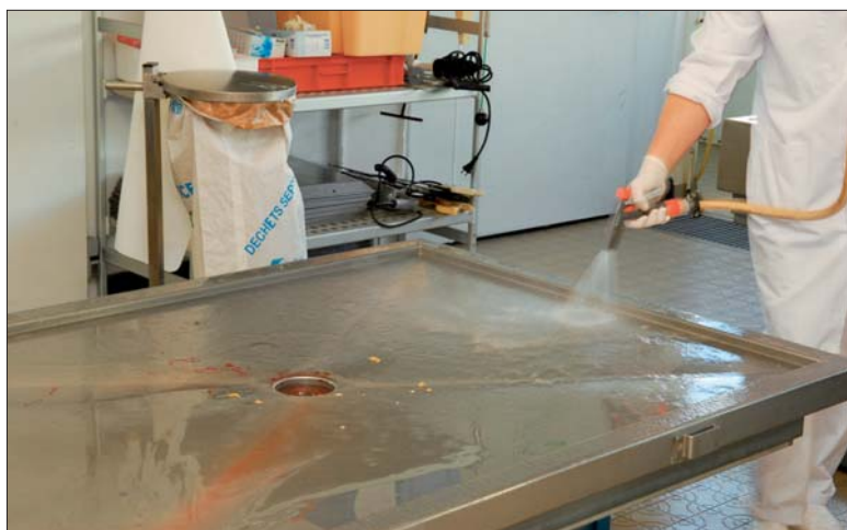
Figure 65. La table d'autopsie résiste aux produits de nettoyage. Elle peut s'élever en fonction des opérateurs ou des animaux autopsiés.
