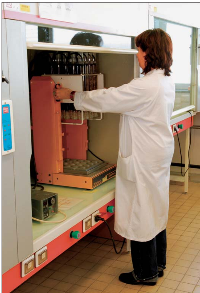
Figure 74. La hauteur de paillasse doit être adaptée aux automates devant rester accessibles au personnel.
