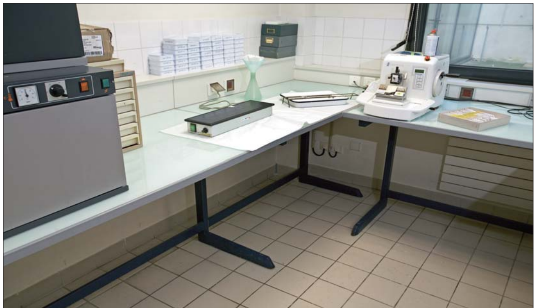
Figure 56. Plan de travail pour la coupe des blocs de paraffine. (Le sol est muni d'un revêtement antidérapant.)
