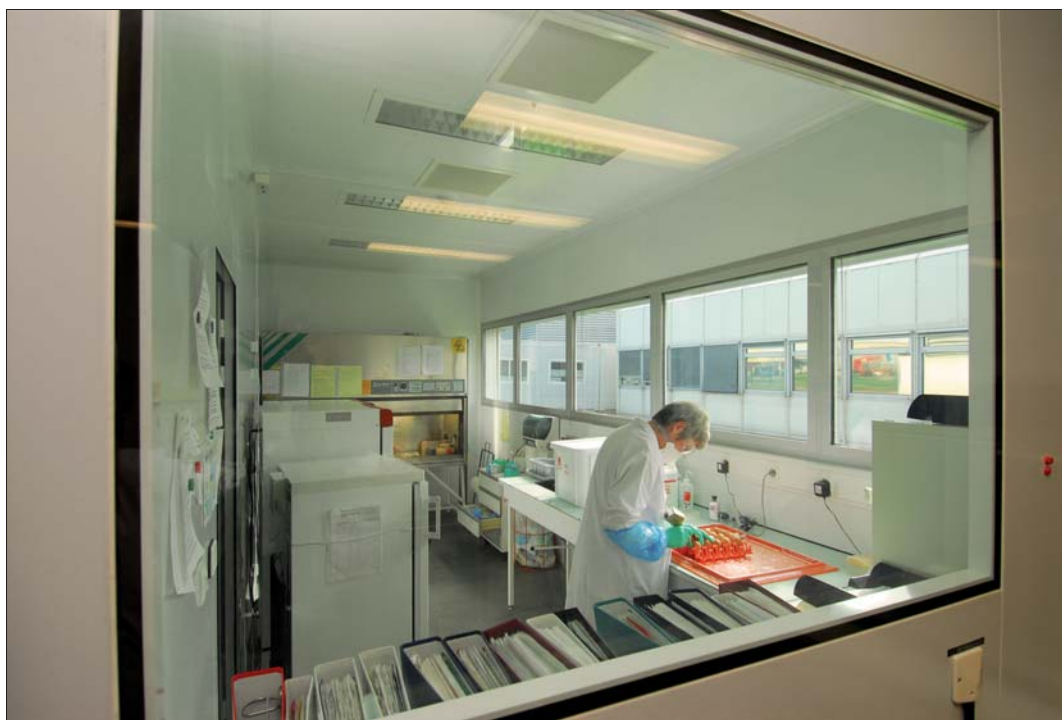
Figure 35. Fenêtre d'observation permettant de voir le personnel travaillant dans la salle technique de niveau de confinement 3.
