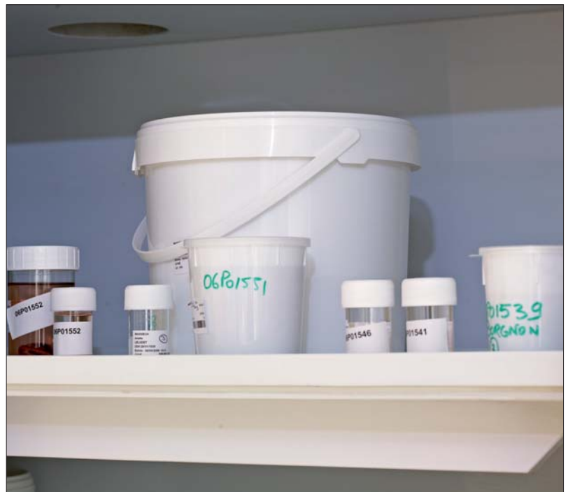
Figures 59 et 60. Les récipients contenant les pièces fixées dans le formol sont stockés dans des armoires ventilées, disposant d'étagères munies d'un dispositif de rétention.
