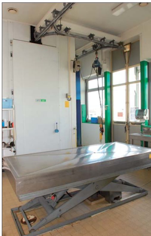
Figure 66. Un rail au plafond permet d'amener sur la table d'autopsie les gros animaux placés dans les box de contention ou dans la chambre froide.
